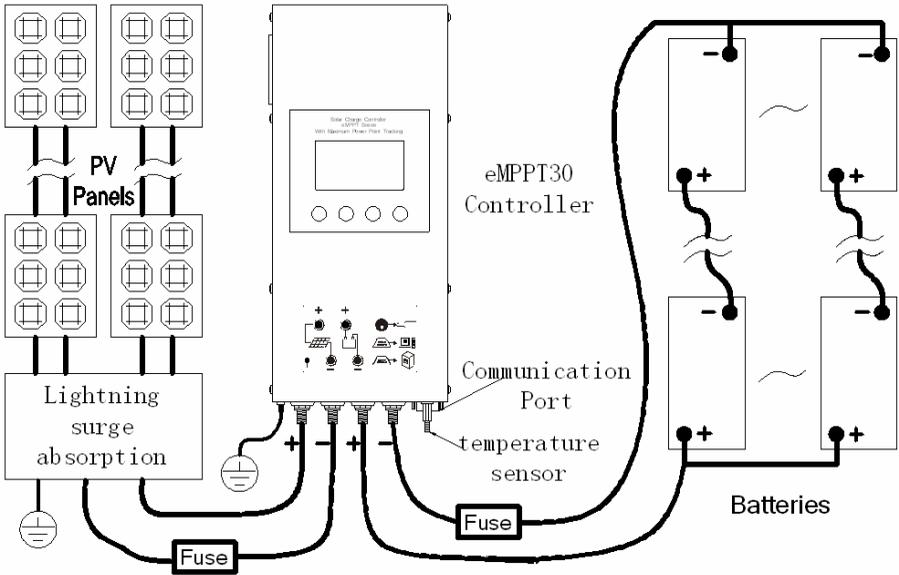
Figure4-2 System wiring diagram
